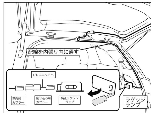
取り外したバックドアゲートにLEDユニットを取り付け配線をします。走行中に振動で動かないよう配線は固定してください。
